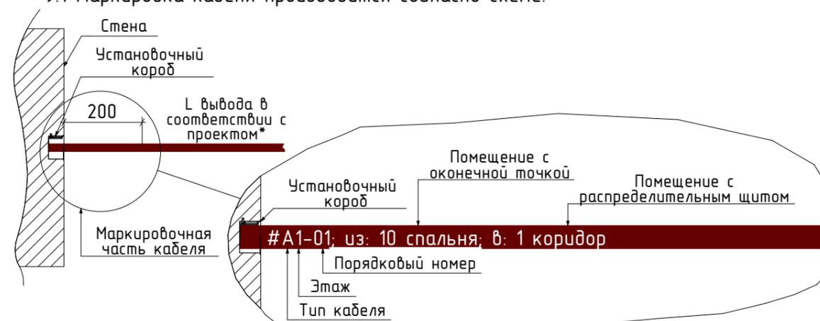
\* Длина вывода кабеля производится в соответствии с проектом. При отсутствии в проекте указаний о длине вывода - длина вывода кабеля составляет 2 м. Длина вывода кабеля в щите составляет не менее 1,5 м.
